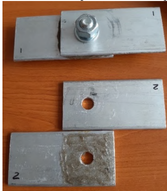
Рис. 4. Нанесення функціонального композитного матеріалу на контактні поверхні
