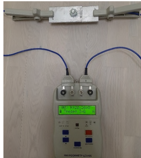
Рис. 5. Вимірювання опору контактного з'єднання
