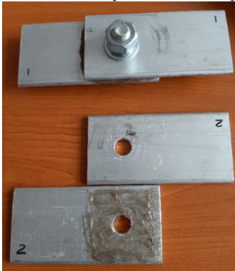
Рис. 4. Нанесення функціонального композитного матеріалу на контактні поверхні
