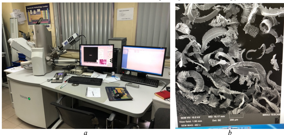
Рис. 2. Загальний вигляд електронного мікроскопу TESCAN Mira 3 LMU (а); дослідження фракцій порошку інтерметаліду Camital (b)
