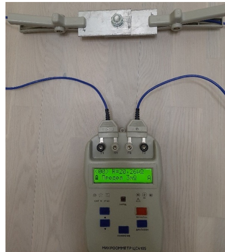
Рис. 5. Вимірювання опору контактного з'єднання
