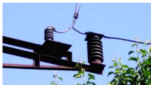
Рис. 3. Образец ОПНп, подготовленный к испытаниям
