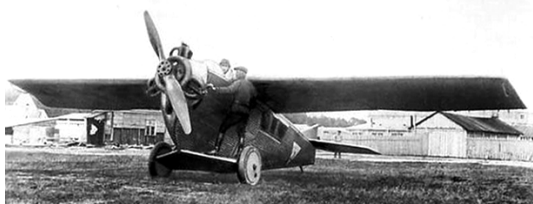
Рис. 2. Один из первых цельнометаллических советских винтовых поршневых самолетов типа АНТ-2 разработки молодого авиаинженера А.Н. Туполева (1924 г.) [5]
