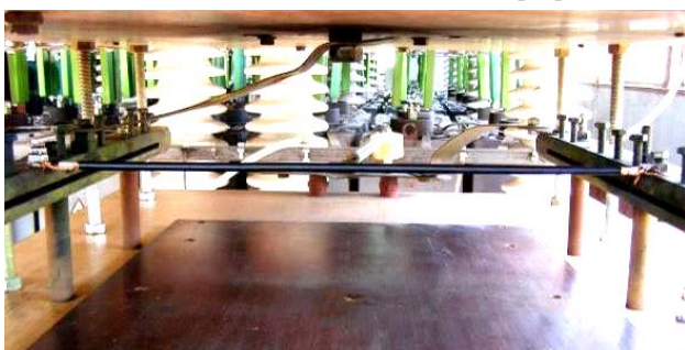
Рис. 4. Общий вид рабочего стола ГТМ с жестко закрепленным на его массивных алюминиевых электродах испытываемого ОО радиочастотного кабеля марки РК 75-4-11 длиной 0,55 м со сплошной медной жилой сечением S_{C1} = 0,407 \text{ мм}^2 и медной оболочкой-оплеткой сечением S_{C2} = 2,44 \text{ мм}^2 до воздействия на него импульсной A -компоненты тока искусственной молнии с нормированными АВП (жила и оболочка-оплетка на концах этого кабеля были включены в сильноточную разрядную цепь ГТМ параллельно) [1, 14]
