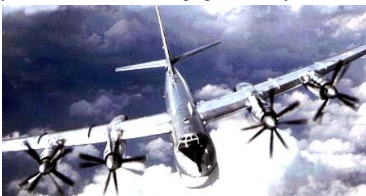
Рис. 8. Советский турбовинтовой четырехмоторный стратегический бомбардировщик типа Ту-95 («Атомный медведь» по терминологии стран НАТО) разработки А.Н. Туполева и его коллег-авиаконструкторов по ОКБ-156 (1956 г.) [7, 8]
