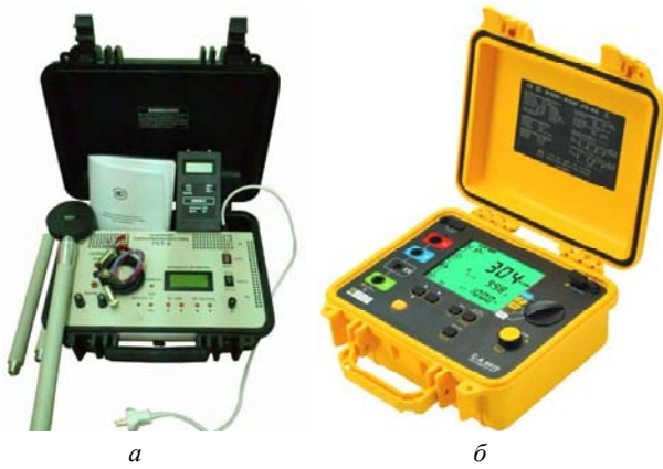
Рис. 4. Прилади для контролю стану ЗП: а – «КДЗ-1У»; б – С.А 6470N
