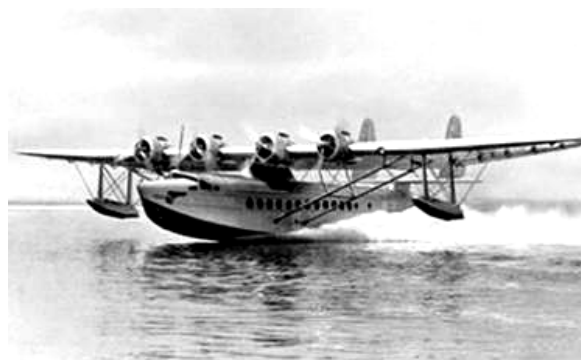
Рис. 6. Четырехмоторный магистральный пятидесятиместный пассажирский самолет-амфибия типа S-44 разработки авиаконструктора И.И. Сикорского (1937 г., США) [2]
