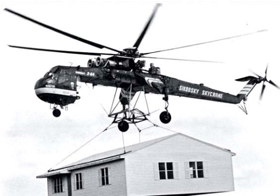
Рис. 9. Общий вид вертолета-крана разработки авиаконструктора И.И. Сикорского в работе (1950-е годы, США) [2]
