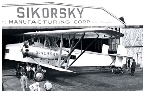
Рис. 4. Один из первых двухмоторных самолетов-бипланов типа S-29 гражданского назначения, разработанных и созданных И.И. Сикорским в «новом свете» (1924 г., США) [2]
