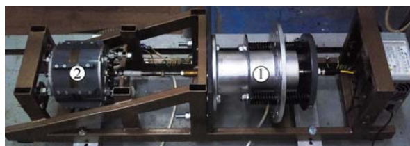
Рис. 2. Конструкція дослідної (а) та навантажувальної (б) машин
