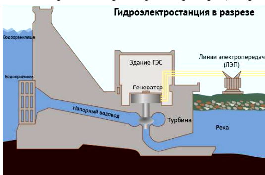
Рис. 2. Принципиальная типичная схема построения ГЭС [2]
