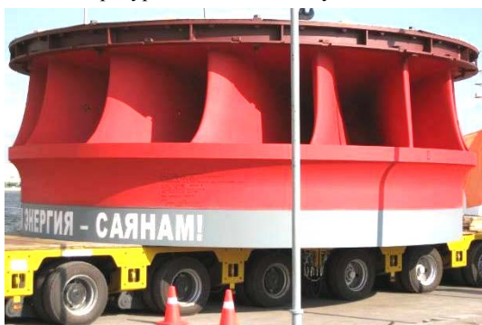
Рис. 5. Общий вид перевозимого на ГЭС рабочего колеса современной мощной радиально-осевой гидротурбины [7]
