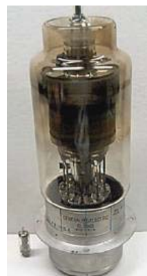
Рис. 5. Общий вид большого водородного тиратрона, используемого в импульсных электроцепях современных радаров (изготовитель – фирма «General Electric», США) [10]
