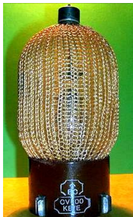
Рис. 6. Общий вид мощного тригatronа типа CV100 [11]
