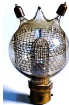
Рис. 2. Общий вид первой российской мощной радиолампы «Бабушка» (Нижегородская радиолaborатория, 1919 г.) [9]
