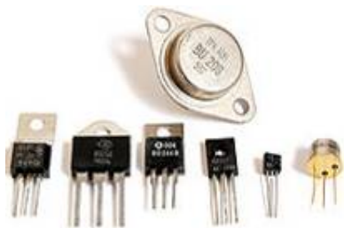
Рис. 9. Общий вид биполярных транзисторов различной конструкции, использующих на одном полупроводниковом кристалле три электрода – базу, управляющий электрод-эмиттер и управляемый электрод-коллектор [16, 17]
