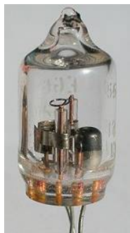
Рис. 7. Общий вид крайatronа-ключа марки KN2 «Krytron» (изготовитель – фирма «EG&G Corporation», США) [13]
