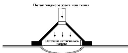
Рис. 4. Схема производственной операции по устранению вмятин с помощью её интенсивного нагрева и последующего резкого охлаждения
