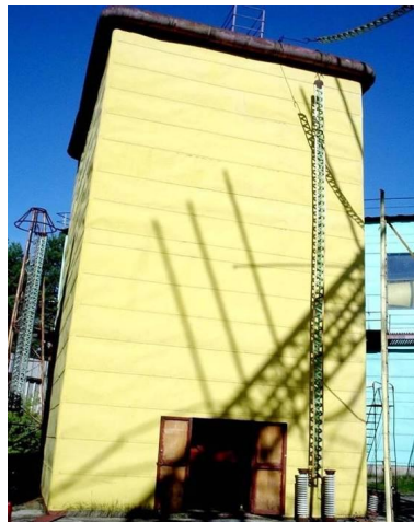
Рис. 1. Общий вид генератора импульсных напряжений ГИН-4 на номинальное напряжение 4 МВ и номинальную запасаемую электрическую энергию 1 МДж, входящего в состав созданного ГКИН на напряжение U_m до 2 МВ [4, 5]
