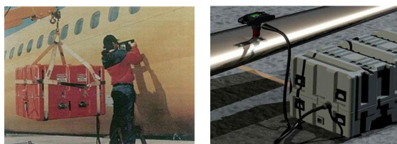
Рис. 2 Системы магнитно-импульсного устранения вмятин в элементах летательных аппаратов: а – разработка фирмы "Electroimpact"; б – оборудование, предлагаемое компанией "Fluxtronic"
