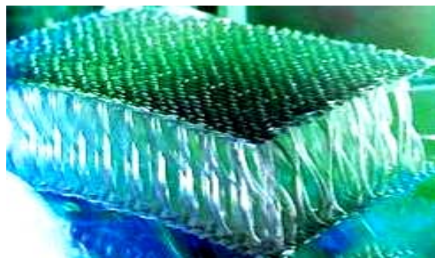
Рис. 2. Общий вид фрагмента оригинальной стеклоткани типа Parabeam 3D Glass fabric, состоящей из двух сотканых горизонтально размещенных параллельных стеклопластин, связанных друг с другом вертикальным стекловорсом, и образующей так называемую «сэндвич-стеклоструктуру» [6]
