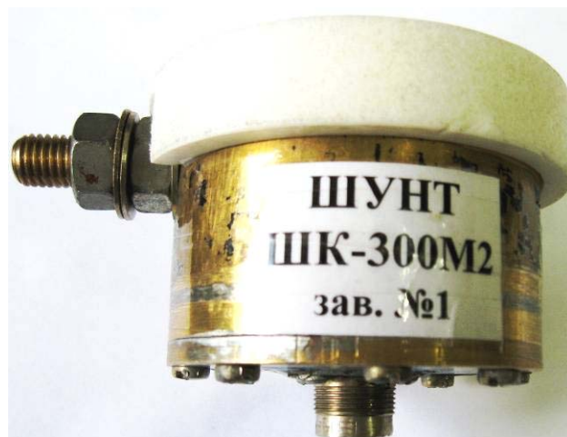
Рис. 1. Общий вид коаксиального дискового шунта типа ШК-300М2, предназначенного для измерения на экранах ЦЗО в согласованном режиме работы его коаксиальной кабельной линии связи мощных импульсов тока искусственной молнии в сильноточной разрядной цепи высоковольтного ГТМ с интегралом их действия до 15 \cdot 10^6\text{ Дж/Ом}
