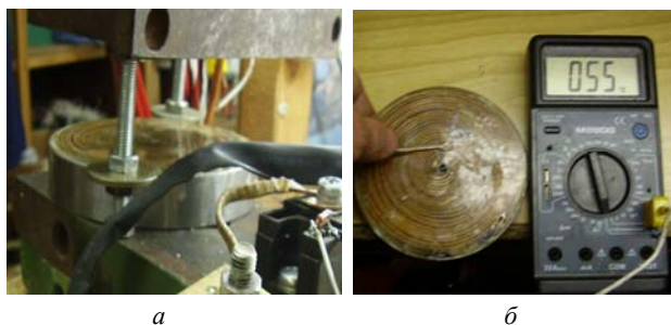
Рис. 10. Экспериментальная установка для исследования ЛИИЭП с тонкостенным стальным каркасом (а) и процесс измерения температуры (б)
