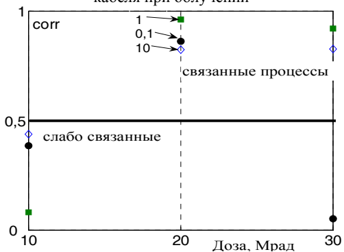
Рис. 4. Корреляция \text{tg } \delta облученных образцов от дозы радиации
