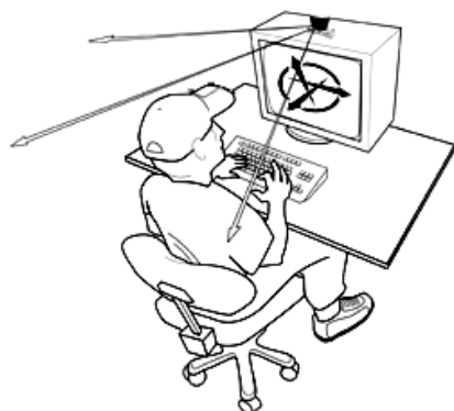
Рис. 8. Система трекинга, отслеживая изменения положения головы, меняет графическую картину
