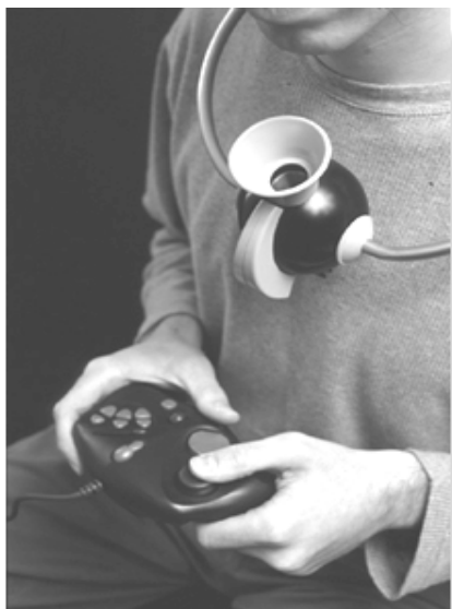
Рис. 12. Генератор запахов: с помощью синтеза фенольных соединений позволяет воссоздавать 10000 ароматических оттенков (исходными фенол-содержащими веществами являются эфирные масла)
