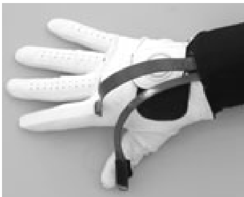
Рис. 11. Сенсорная перчатка, позволяющая ощущать объём поверхностей и их температуру
