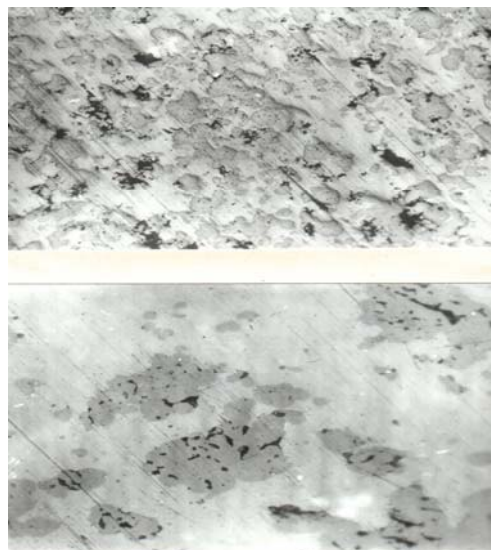
Рис. 3. Микроструктура контактов с примесью активатора (ув.100-500)
