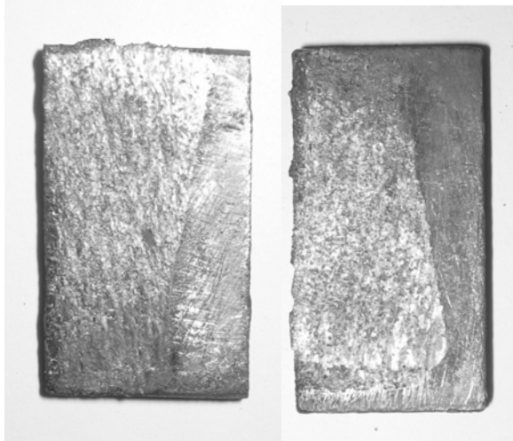
Рис. 5. Напайки на головні контакти (нерухомий – зліва; рухомий – справа)
