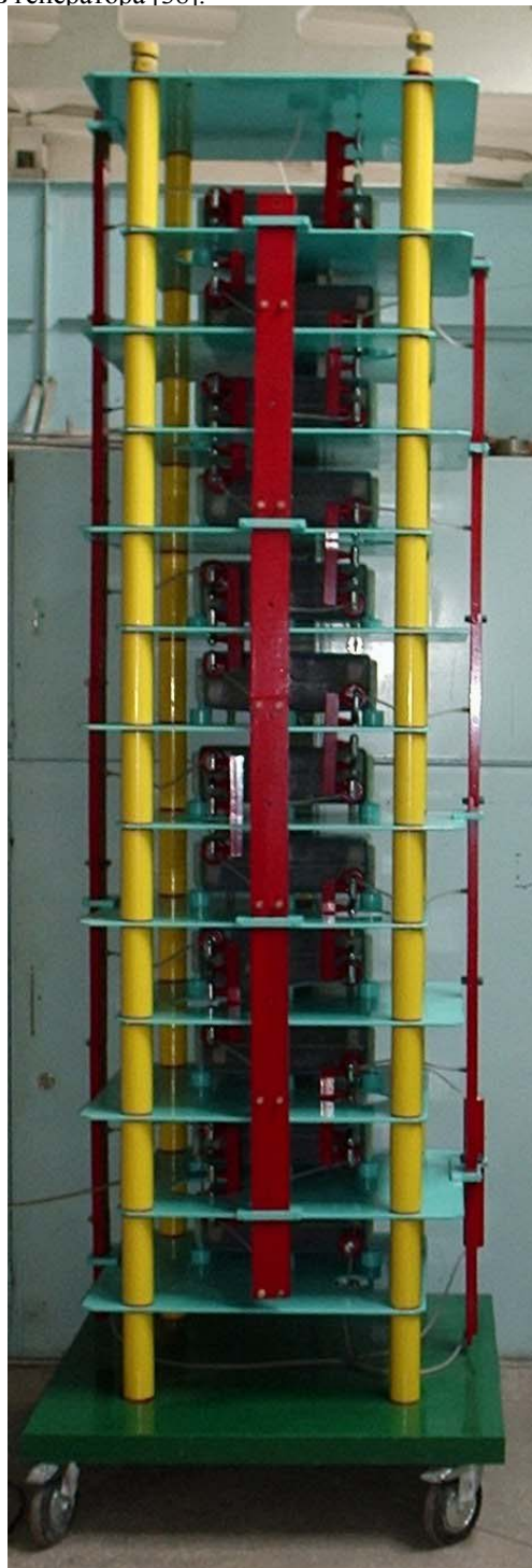
Рис. 7. Общий вид передвижного ГИН на номинальное напряжение 1,2 МВ с запасаемой энергией в 15 кДж
