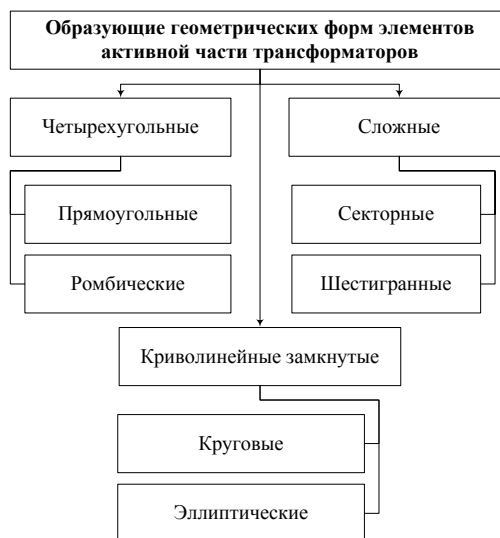
Рис. 5. Диаграмма классификации образующих геометрических форм катушек обмоток и сечения стержней магнитопроводов трансформаторов
