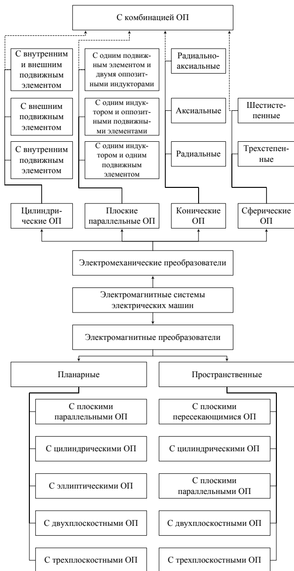
Рис. 1. Диаграмма обобщенной классификации электромагнитных систем электрических машин
