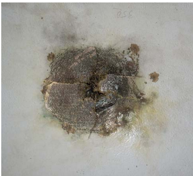
Рис. 16. Общий вид зоны повреждения Ø 100 мм при воздействии импульсной компоненты A тока молнии на опытном образце толщиной 3 мм композиционной обшивки ЛА
