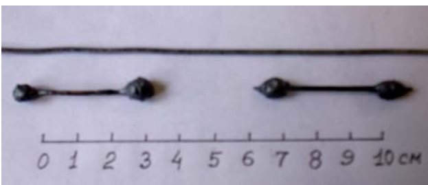
Рис. 8. Общий вид элементов исследуемого оцинкованного стального провода до (вверху) и после (внизу) воздействия на них мощного апериодического импульса тока проводимости i_n(t) большой плотности ( \delta_{мп} = 0,37 кА/мм 2 )
