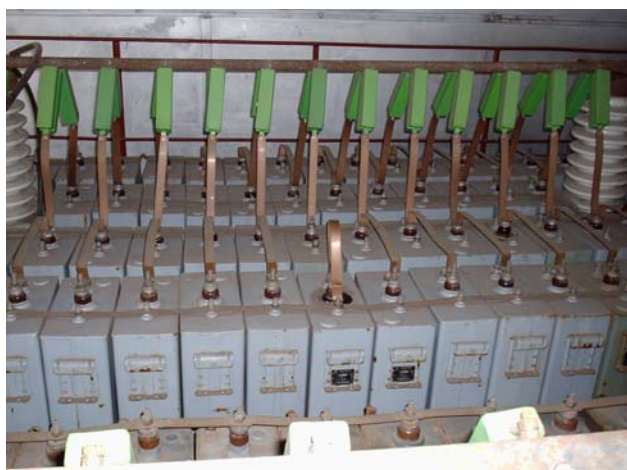
Рис. 10. Общий вид третьего этажа мощного ЕНЭ на \pm 5 кВ, медной ошиновки и защитных керамических резисторов типа ТВО-60-100 Ом разрядной цепи имитатора – C
