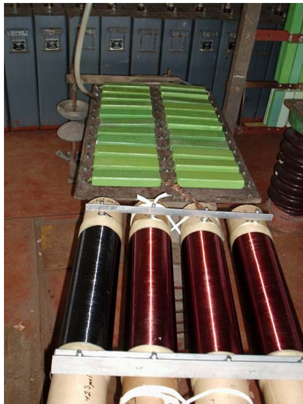
Рис. 8. Общий вид развязывающих RL-элементов разрядной цепи имитатора – В
