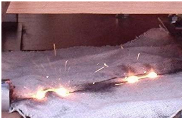
Рис. 3. Тепловое состояние исследуемого оцинкованного стального провода после интенсивного электротеплового воздействия на него мощного аperiodического импульса тока i_{\text{п}}(t) большой плотности ( \delta_{\text{мп}}=0,37 кА/мм 2 )
