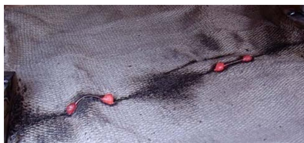
Рис. 11. Общий вид остывающих макроскопических "горячих" (бывших макроскопических зон ВЭП провода) и "холодных" продольных участков провода ( n \approx 9 )
