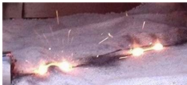
Рис. 10. Опытное распределение вдоль провода "горячих" (макроскопических зон ВЭП провода) и "холодных" продольных участков ( n \approx 9 )
