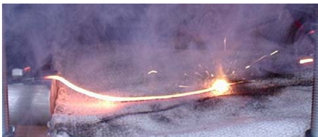
Рис. 6. Опытное распределение вдоль провода "горячих" (макроскопических зон ВЭП провода) и "холодных" продольных участков ( n \approx 2 )
