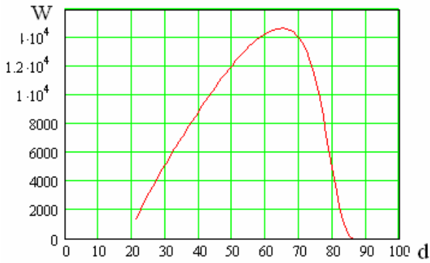
Рис. 4. Зависимость энергии магнитного поля сосредоточенной в воздушном зазоре от диаметра расточки статора
