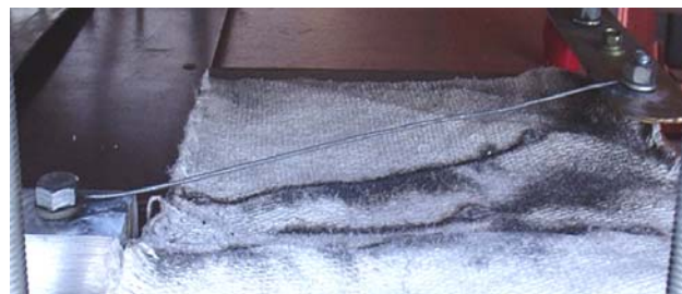
Рис. 1. Общий вид исследуемого оцинкованного стального провода до воздействия на него мощного аperiodического импульса тока с амплитудой I_{mc} от генератора ГИТ-5С
