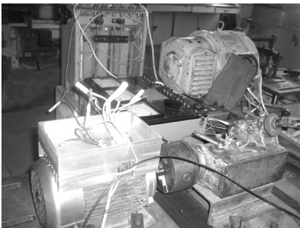
Рис. 4. Вентильный индукторно-реактивный двигатель, спаренный с делительной головкой
