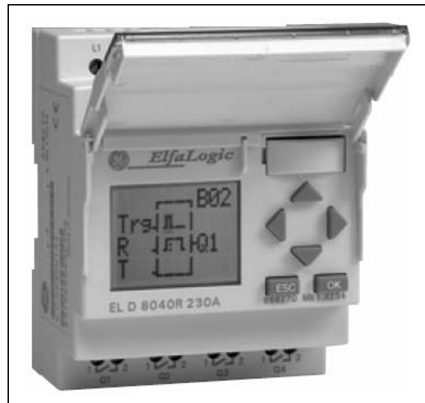
Рис. 15. Зовнішній вигляд багатофункціонального програмованого логічного контролера (ПЛК)
