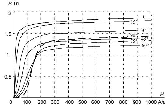
Рис. 1. Кривые намагничивания холоднокатаной стали марки 3405
