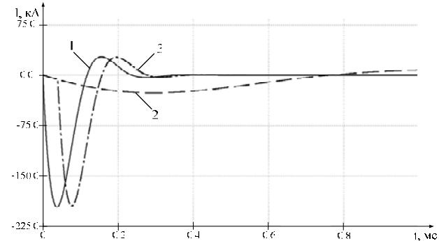
Рис. 7. График изменения тока в разрядной цепи ГИТ-А
