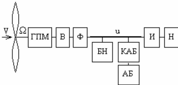
Рис. 1. Функциональная схема ВЭУ
