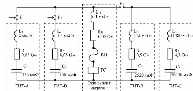
Рис. 2. Эквивалентная электрическая схема разрядных цепей генератора: ГИТ-А, ГИТ-Д, ГИТ-В, ГИТ-С – разрядные цепи генераторов соответствующих компонент А, В, С, Д; ВП – взрывающийся проводник; ТС – испытываемое техническое средство
