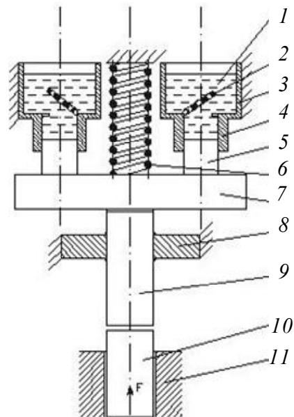
Рис. 1. Антидриблнговое устройство с отскакивающим грузом: 1 – масло; 2 – клапан с фильтрными отверстиями; 3 – резервуар; 4 – цилиндр; 5 – поршень; 6 – возвратная пружина; 7 – груз; 8 – фланец; 9 – неподвижный контакт; 10 – подвижный контакт; 11 – направляющая втулка
