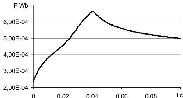
Рис. 6. Временная зависимость магнитного потока
