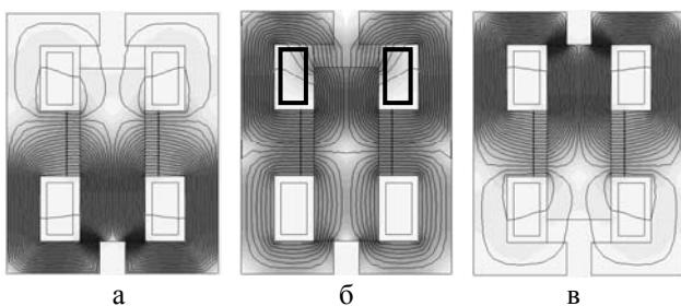
Рис. 8. Распределение магнитного поля в электромагнитном приводе вакуумного контактора ABB в разных режимах: а – катушки обесточены, контактор отключен; б – на катушку включения подано напряжение; в – катушки обесточены, контактор включен
