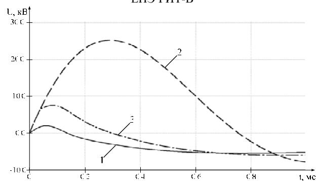
Рис. 5. График изменения тока в разрядной цепи ГИТ-В
