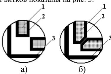
Рис. 3. Профили сечения витков индукторов в углах деформируемой трубы: 1 – металл витка, 2 – изоляция, 3 – металл заготовки
