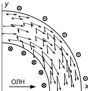
Рис. 6. Совмещенное распределение векторов магнитной индукции ( $\rightarrow$ ) и напряженности поля ( $\cdots\cdots\cdots$ ) в цилиндрическом образце из анизотропной стали (ось легкого намагничивания направлена по оси  $x$ )
