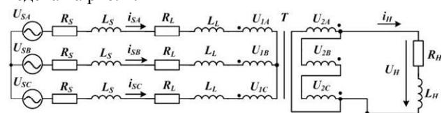
Рис. 1. Эквивалентная схема традиционной системы электроснабжения
