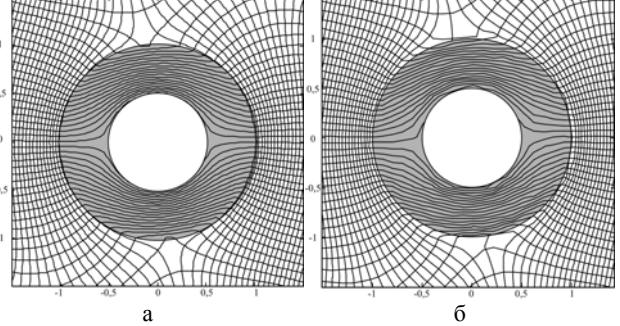
Рис. 3. Картине поля в окрестности основного цилиндра при направлении вектора напряженности  $H_0$  вдоль горизонтальной оси: а – поле рассчитано по выражениям (1) – (3); б – поле рассчитано численным методом
