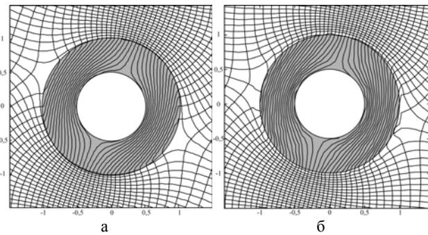
Рис. 5. Картина поля в окрестности основного цилиндра при направлении вектора напряженности  $H_0$  под углом  $75^\circ$  к горизонтальной оси (вдоль периода  $\omega_2$ ): а – поле рассчитано по выражениям (1) – (3); б – поле рассчитано численным методом
