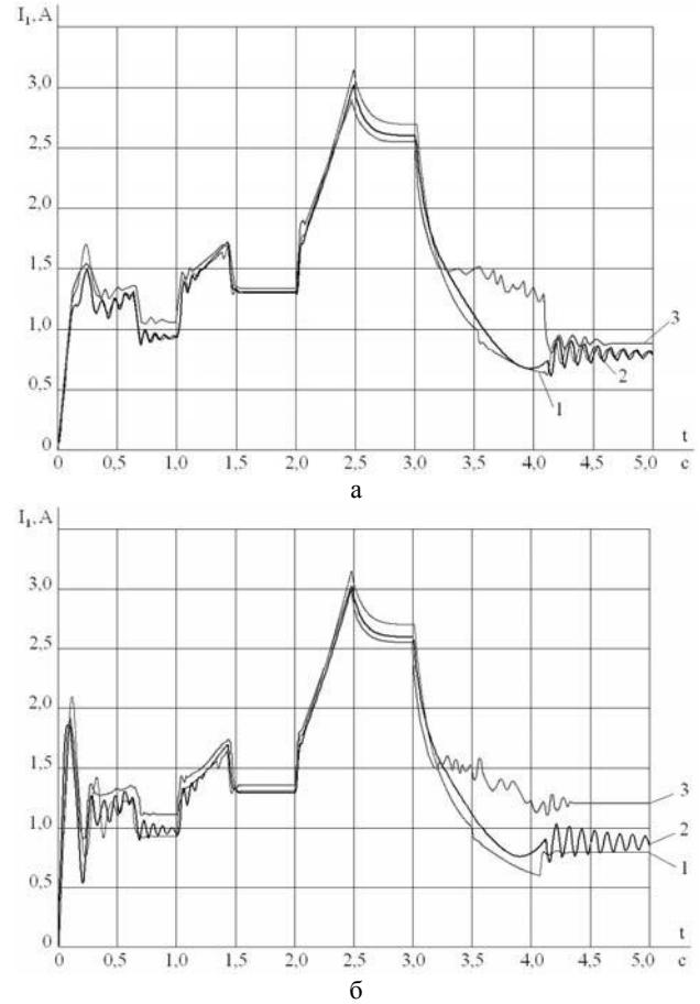
Рис. 1. Изменение тока статора при отработке заданной тахограммы для различных законов управления:
