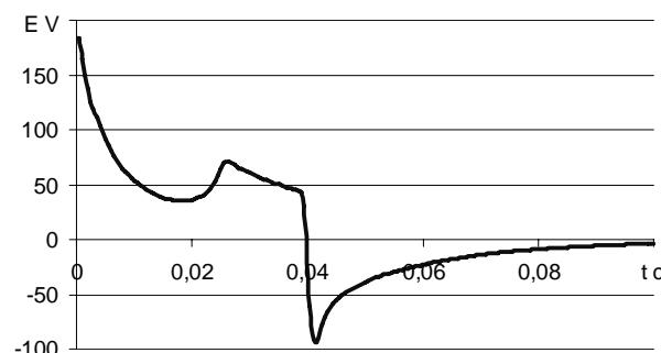
Рис.7. Временная зависимость противоЭДС катушки
