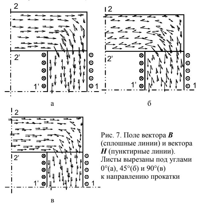
Рис. 7. Поле вектора  $B$  (сплошные линии) и вектора  $H$  (пунктирные линии). Листы вырезаны под углами  $0^\circ$ (а),  $45^\circ$ (б) и  $90^\circ$ (в) к направлению прокатки
