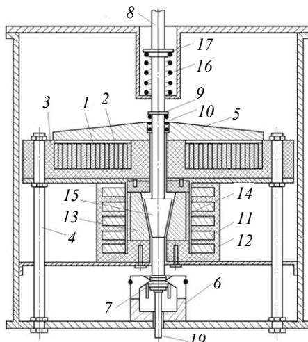
Рис. 2. Короткозамыкаль с антидриблнговым устройством:
