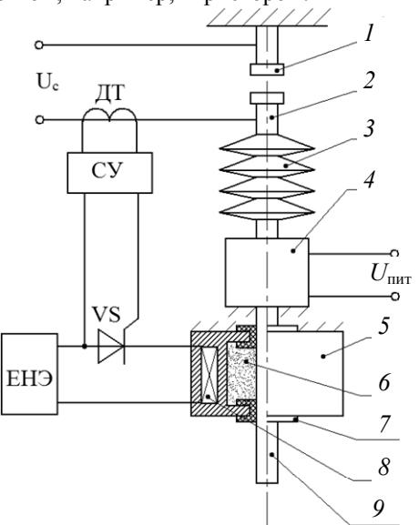
Рис. 4. Антидриблнговое устройство коммутатора
