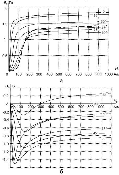
Рис. 3. Характеристики намагничивания стали 3405:
