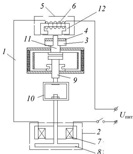
Рис. 3. Вакуумный выключатель с противоотскокным
