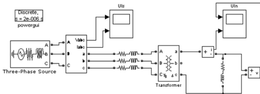
Рис. 2. MatLab – модель традиционной системы электроснабжения
