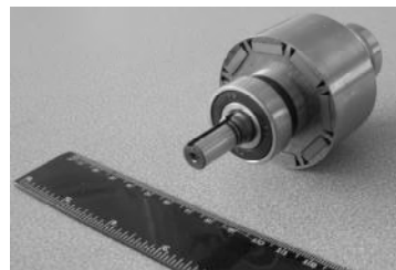
Рис. 4. Ротор макетного образца ВД с внутренними ПМ
