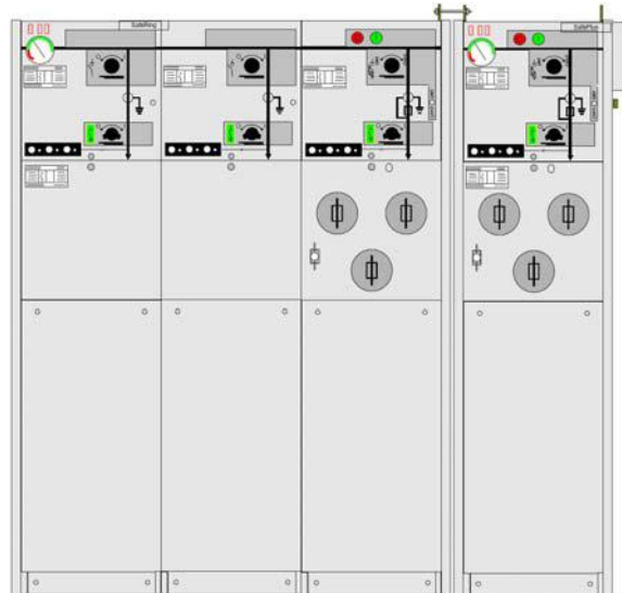
Рис. 24. Два блоки, з'єднані за допомогою аксесуарів бокового розширення
