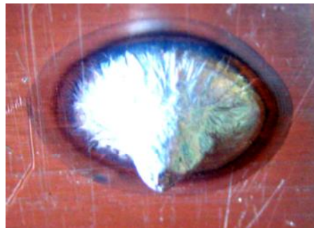
Рис. 13. Внешний вид внутренней зоны сквозного проплавления образца из алюминиевого сплава АМг2М толщиной 2 мм от совместного воздействия на него импульсной А- и длительной С- компонент тока искусственной молнии
