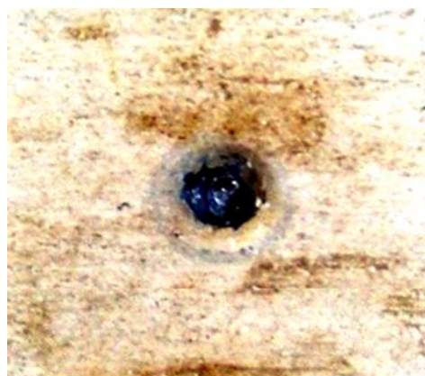
Рис. 19. Внешний вид внутренней зоны частичного проплавления образца из алюминиевого сплава АД5М толщиной 5 мм от совместного воздействия на него импульсной А- и длительной С- компонент тока искусственной молнии
