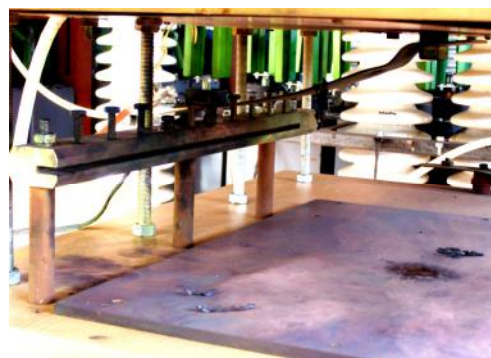
Рис. 16. Внешний вид рабочего стола ГТМ и испытываемого образца кабеля РК 75-4-11 с медной жилой сечением 0,407 \text{ мм}^2 и медной оплеткой сечением 3,44 \text{ мм}^2 после воздействия на него импульсной А- компоненты тока искусственной молнии с амплитудой I_{mA}=-184,7 \text{ кА}
