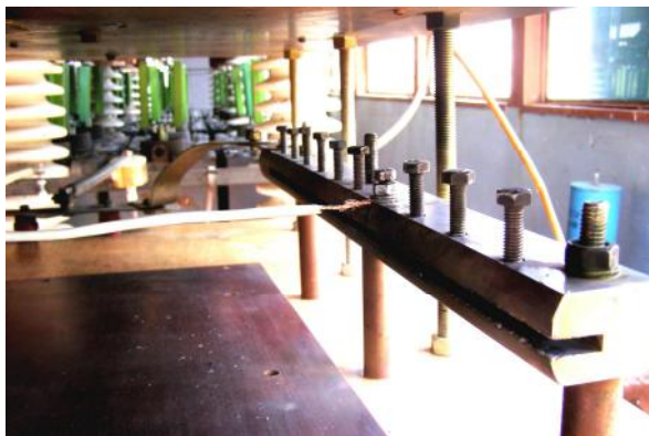
Рис. 26. Внешний вид рабочего стола ГТМ и испытываемого образца неэкранированной витой пары UTP cat5 с восемью медными жилами общим сечением 1,6 мм 2 до воздействия на нее длительной C -компоненты тока искусственной молнии с амплитудой I_{mC} = -0,835 кА
