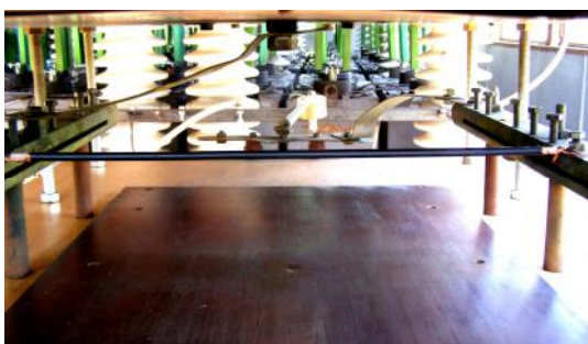
Рис. 19. Внешний вид рабочего стола ГТМ и испытываемого образца радиочастотного кабеля РК 75-4-11 с медной жилой сечением 0,407 \text{ мм}^2 и медной оплеткой сечением 3,44 \text{ мм}^2 после воздействия на него длительной C -компоненты тока искусственной молнии с амплитудой I_{mC} = -0,891 \text{ кА}
