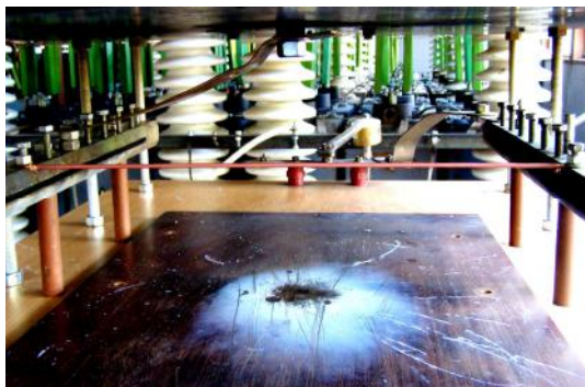
Рис. 8. Внешний вид рабочего стола ГТМ и испытываемого образца одиночного провода ПВ-2,5 с расщепленной медной жилой сечением 2,5 \text{ мм}^2 до воздействия на него импульсной А-компоненты тока искусственной молнии с зарегистрированной амплитудой I_{mA} = -166,7 \text{ кА}
