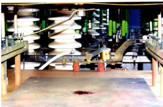
Рис. 9. Внешний вид рабочего стола ГТМ и испытываемого образца одиночного провода ПВ-2,5 с расщепленной медной жилой сечением 2,5 \text{ мм}^2 после воздействия на него импульсной А-компоненты тока искусственной молнии с зарегистрированной в процессе ее электровзрыва амплитудой I_{mA} = -166,7 \text{ кА}
