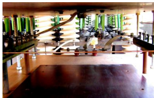
Рис. 11. Внешний вид рабочего стола ГТМ и испытываемого образца кабеля РК 75-17-31 с медной жилой сечением 10,2 \text{ мм}^2 до воздействия на него импульсной А-компоненты тока искусственной молнии с амплитудой I_{mA} = -205 \text{ кА}
