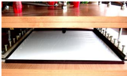
Рис. 2. Внешний вид рабочего стола ГТМ, примененного при испытаниях коротких образцов медных проводов (кабелей) бортовых электрических цепей ЛА на электротермическую стойкость к импульсной А- и длительной С- компонентам тока искусственной молнии с нормированными АВП
