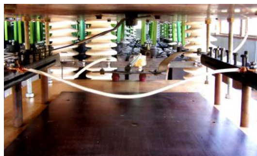
Рис. 21. Внешний вид рабочего стола ГТМ и испытываемого образца провода БПВЛ с медной жилой сечением 12 \text{ мм}^2 после совместного воздействия на него импульсной A -компоненты тока молнии амплитудой I_{mA} = -205 \text{ кА} и длительной C -компоненты тока молнии амплитудой I_{mC} = -0,880 \text{ кА}
