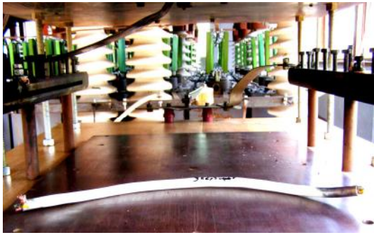
Рис. 25. Внешний вид рабочего стола ГТМ и испытываемого образца кабеля ПВС 3x2,5 с тремя медными жилами общим сечением 7,5 мм 2 после воздействия на него импульсной A -компоненты тока молнии амплитудой I_{mA} = -200 кА
