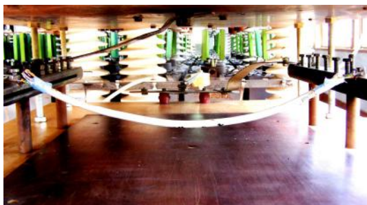
Рис. 22. Внешний вид рабочего стола ГТМ и испытываемого образца экранированного многожильного кабеля UNITRONIC LIYCY 20x0,34 Pbf с шестью его параллельно подключенными медными жилами общим сечением 2,04 мм 2 до воздействия на него длительной C - компоненты тока искусственной молнии с амплитудой I_{mC} = -0,857 кА
