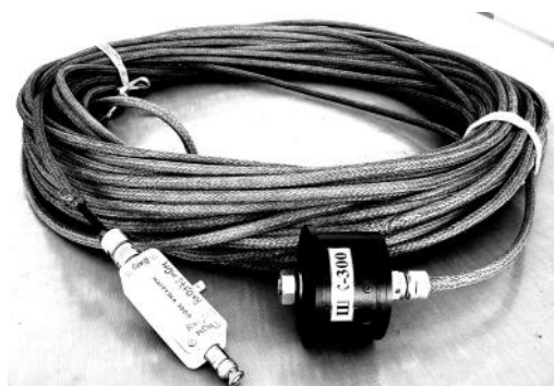
Рис. 5. Общий вид измерительного коаксиального шунта ШК-300 с экранированной кабельной линией связи длиной 60 м и специальным делителем напряжения СД-300 [2, 4]
