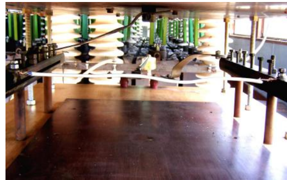
Рис. 27. Внешний вид рабочего стола ГТМ и испытываемого образца неэкранированной витой пары UTP cat5 с восемью медными жилами общим сечением 1,6 мм 2 после воздействия на нее длительной C -компоненты тока искусственной молнии с амплитудой I_{mC} = -0,835 кА
