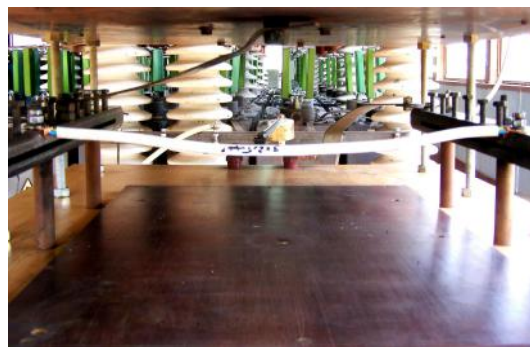
Рис. 24. Внешний вид рабочего стола ГТМ и испытываемого образца кабеля ПВС 3x2,5 с тремя медными жилами общим сечением 7,5 мм 2 до воздействия на него импульсной A - компоненты тока молнии амплитудой I_{mA} = -200 кА
