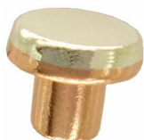
Рис. 7. Біметалевий контакт: 1 – несуча мідна ніжка; 2 – робочий (контактний) шар. Робочий шар зварюється з шляпкою ніжки за допомогою установки контактного зварювання.
