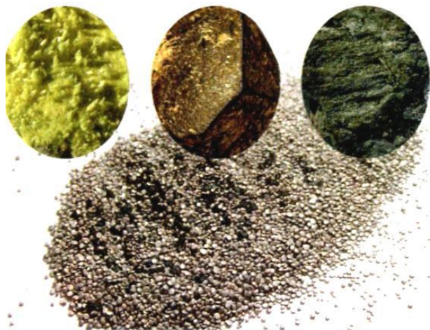
Рис. 2. Внешний вид основных компонент дымного пороха (вверху слева-направо серы, калиевой селитры и древесного угля), применяемых при его (внизу) изготовлении [8]
