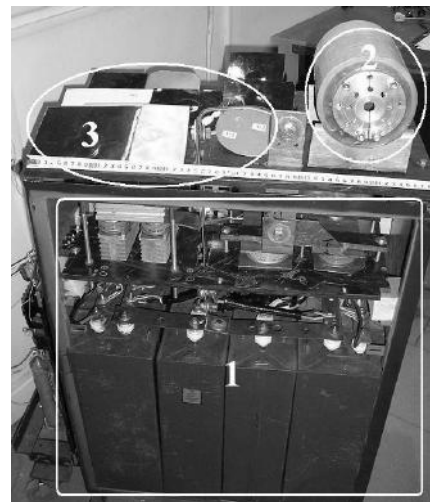
Рис. 1. Экспериментальный магнитно-импульсный комплекс: 1 – источник мощности (силовоточный генератор), 2 – индукторная система-инструмент, 3 – экспериментальные образцы
