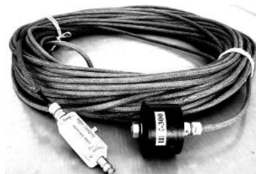
Рис. 3. Внешний вид измерительного коаксиального шунта типа ШК-300 с экранированной кабельной линией связи длиной 60 м и специальным делителем напряжения СД-300, предназначенным для подключения в экранированном заглубленном бункере ряда цифровых осциллографов [1, 3]
