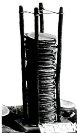
Рис. 5. Внешний вид исторического образца первого в мире источника постоянного электрического тока – гальванического "Вольтова столба", ставшего музейным экспонатом (Италия) [3]
