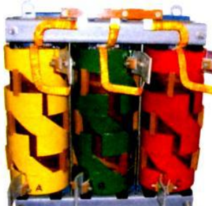
Рис. 12. Внешний вид внутренней выемной электрической части современного мощного трехфазного электрического трансформатора переменного тока [13]
