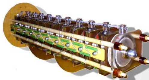
Рис. 9. Внешний вид малогабаритного ГИН на 1 МВ разработки НИПКИ "Молния" НТУ "ХПИ" 2008 года, работающего в жидкой среде трансформаторного масла внутри металлического бака формирователя специальных наносекундных импульсов напряжения и тока [74]
