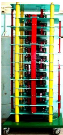
Рис. 8. Внешний вид передвижного ГИН на номинальное напряжение 1,2 МВ и запасаемую энергию 15 кДж разработки НИПКИ "Молния" НТУ "ХПИ" 2006 года, работающего на открытом воздухе и формирующего стандартные грозовые и коммутационные импульсы напряжения [15, 73]
