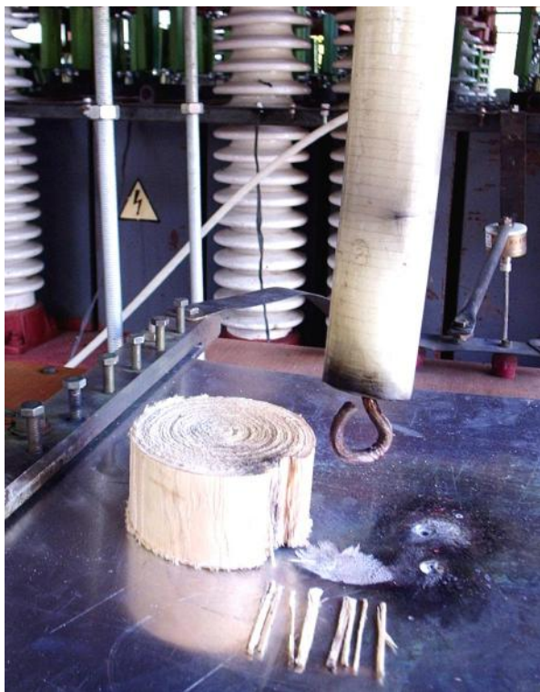
Рис. 5. Внешний вид нижней части ДЭС разрядной цепи высоковольтного генератора ГИТ-А, зоны разрушения и отдельных расколов током молнии элементов опытного образца "живой" древесины сосны диаметром d_H=100 \text{ мм} и высотой h_H=50 \text{ мм} при U_{3A}=-10 \text{ кВ} и I_{mA}=65,7 \text{ кА}
