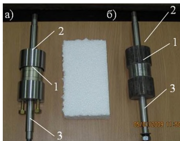
Рис. 1. Якорь вибровозбудителя КЛСД: а) КЛСД-ПМ-А; б) КЛСД-ПМ-Р
