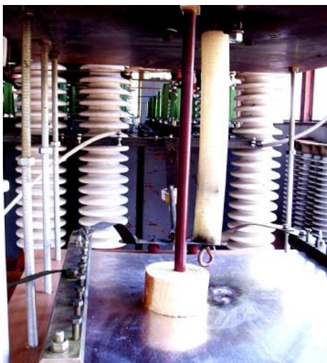
Рис. 2. Внешний вид перед испытанием ДЭС в разрядной цепи высоковольтного генератора ГИТ-А с жестко закрепленным в ней круглым испытательным образцом древесины сосны наружным диаметром d_H=100 мм и высотой h_H=50 мм
