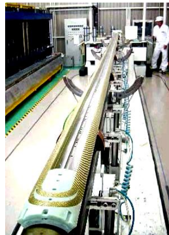
Рис. 8. Внешний вид сверхпроводящей обмотки элемента магнитной системы ускорительного кольца большого адронного коллайдера (2006 г., CERN, Швейцария) [16]
