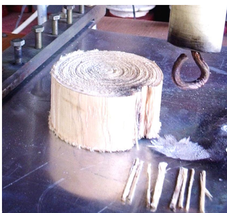
Рис. 3. Внешний вид локального разрушения (раскалывания) в области периферии опытного образца "живой" древесины сосны диаметром d_H=100 мм и высотой h_H=50 мм с помощью канала искрового разряда в цепи генератора тока искусственной молнии при U_{3A}=-10 кВ и I_{mA}=-65,7 кА [1]
