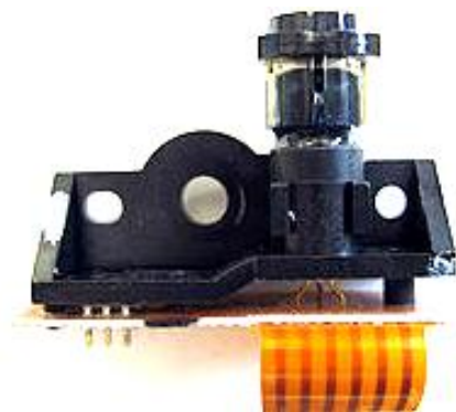
Рис. 8. Полупроводниковый лазер, широко применяемый в узле генерации изображения принтера Hewlett-Packard [6]
