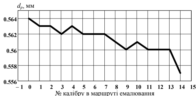
Рис. 2. Діаметр мідного провідника d_p після проходження відповідного калібру в маршруті емалювання: впродовж маршруту відбувається технологічна витяжка провідника, яка складає більше одного відсотка
