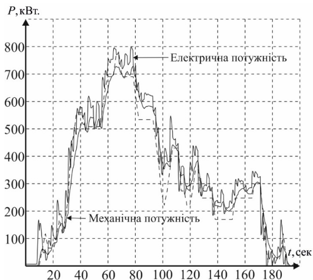
Рис. 6. Виміряні та модельовані графіки залежності споживаної ПП потужностей: --- моделювання, — вимірювання
