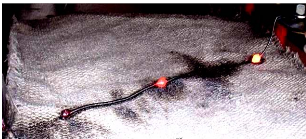
Рис. 6. Внешний вид опытного распределения вдоль стального оцинкованного провода ( r_0=0,8 мм; l_0=320 мм; \Delta l_0=5 мкм; S_0=2,01 мм 2 ) остывающих на воздухе и теплозащитном асбестовом полотне макроскопических трех «горячих» (высокотемпературных зон ВЭП провода шириной \Delta z_{nh} \approx 7 мм) и четырех «холодных» (двух крайних шириной \Delta z_{nc} \approx 50 мм при полной сублимации одного из них и двух внутренних шириной \Delta z_{nc} \approx 100 мм) продольных участков после протекания по нему аperiodического импульса тока i_0(t) отрицательной полярности временной формы t_m/\tau_p \approx 9 мс/160 мс большой плотности ( I_{0m} \approx -745 А; \delta_{0m} \approx 0,37 кА/мм 2 ; n=3 ; t_0 \approx 576 мс) [20]
