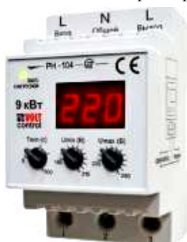
Рис. 24. Внешний вид отечественного реле напряжения типа VOLT CONTROL PH-104 (ток – до 40 А; напряжение – (160-280) В; время задержки – (5-900) с; Украина) [48]
