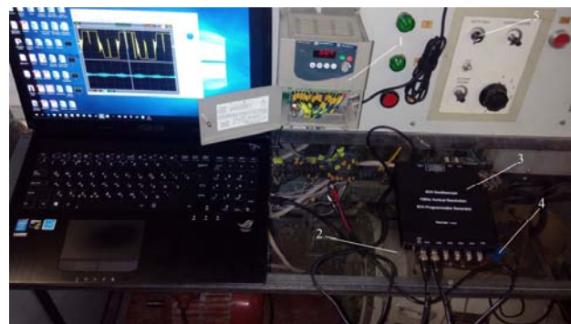
Рис. 7. Зовнішній вигляд лабораторної установки: 1 – частотний перетворювач; 2 – двохобмотковий AD ; 3 – осцилограф; 4 – датчик струму; 5 – регулювання струму навантаження
