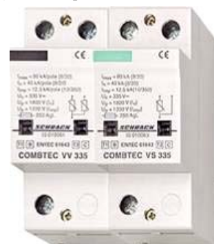
Рис. 8. Внешний вид мощных грозозащитных разрядников типа COMBTEC VV 335 и COMBTEC VS 335, коммутирующих импульсные токи 10/350 мкс молнии амплитудой до 40 кА и ограничивающих грозовые перенапряжения для электротехнического оборудования до уровня 1 кВ [35]
