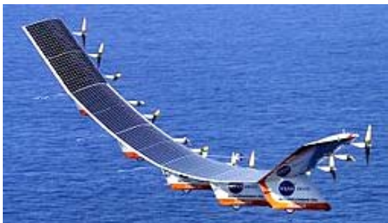
Рис. 17. Беспилотный самолёт NASA «Pathfinder Helios» с ФЭЭ, установленными на его оригинальных крыльях [3]
