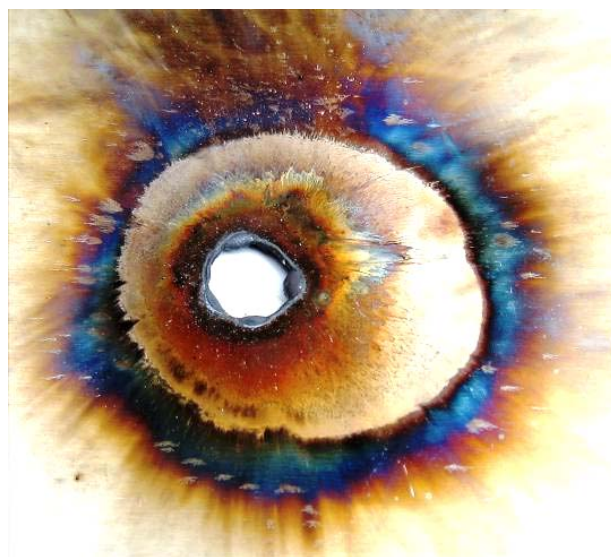
Рис. 12. Внешний вид округлой зоны диаметром около 12 мм сквозного проплавления плоской стенки ИО стальной кровли ( h=1 мм; h_a=14 мм) от прямого действия на него длительной C - компоненты тока искусственной молнии и округлой зоны диаметром до 58 мм ее поверхностного оплавления от прямого действия на ИО импульсной A - компоненты ее тока с нормированными по требованиям [3, 4] АВП
