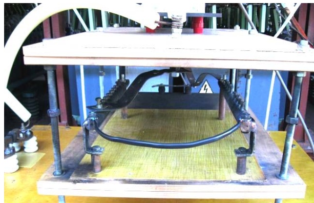
Рис. 10. Внешний вид рабочего стола генератора типа ГИТМ-10/350 с жестко закрепленной на его массивных стальных электродах сплошной круглой алюминиевой жилой сечением S_1 \approx 6 \text{ мм}^2 ОО провода марки АППВнг2×6 с ПВХ изоляцией длиной 0,5 м до воздействия на нее аperiodического импульса тока 15/335 мкс искусственной молнии амплитудой около I_{mL} \approx 85,6 \text{ кА} ( U_{31-3} \approx 16,5 \text{ кВ} ; U_{34} \approx 4,2 \text{ кВ} )
