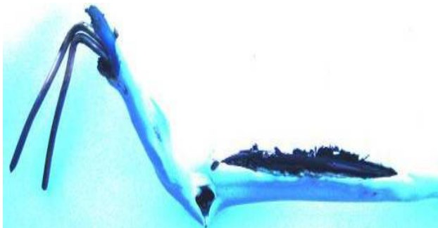
Рис. 9. Внешний вид фрагмента ОО провода марки ПНП 2×2,5 с ПВХ изоляцией с двумя параллельно соединенными в разрядной цепи генератора типа ГИТМ-10/350 круглыми медными жилами общим сечением S_1 \approx 5 \text{ мм}^2 после протекания по ним испытательного аperiodического импульса тока 17/335 мкс искусственной линейной молнии ( I_{mL} \approx 83,8 \text{ кА} ; \delta_{m1} \approx I_{mL}/S_1 \approx 16,8 \text{ кА/мм}^2 ; \tau_r \approx 17 \text{ мкс} ; t_m \approx 28 \text{ мкс} ; \tau_p \approx 335 \text{ мкс} ; J_L \approx 1,91 \cdot 10^6 \text{ А}^2 \cdot \text{с} ; q_L \approx 41,2 \text{ Кл} ; U_{31-3} \approx 16,5 \text{ кВ} ; U_{34} \approx 4,2 \text{ кВ} )
