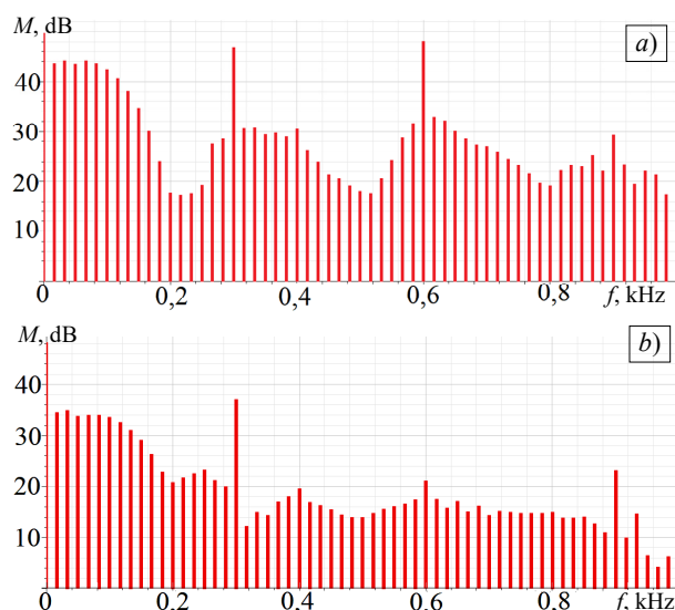
Рис. 12. Спектрограми моменту при одношаровій обмотці статора (a) та при двошаровій обмотці при зміщенні фаз головної і збуджуючої обмоток на 2 пази (b)
