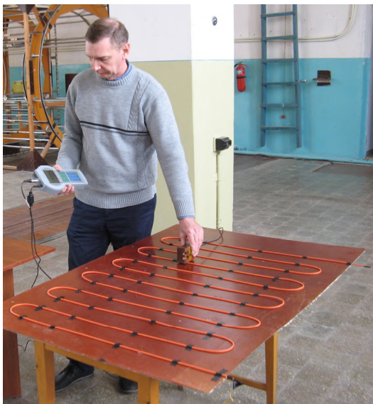
Рис. 10. Дослідження розподілу індукції МП лабораторного макету КСЕ з коаксialними НК типу «VOLTERM» на магнітовимірювальному стенді ІПМаш НАН України
