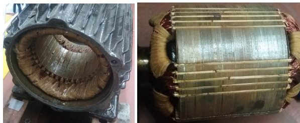
Рис. 11. Активна частина якоря (а) та ротора (б) експериментального зразка АСЕМ
