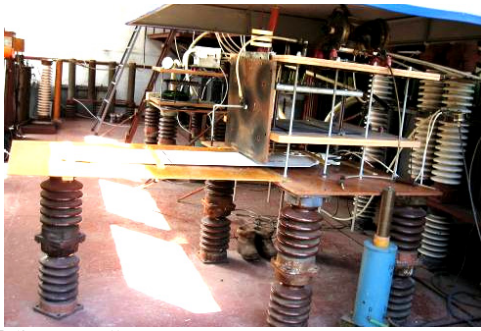
Рис. 5. Загальний вигляд удосконаленого потужного високовольтного ГСБ типу УИТОМ-1 (на передньому плані знаходиться робочий стіл з трьохелектродним комутатором F_1 на номінальну постійну напругу \pm 50 кВ і системою повітряної витяжки, а на задньому плані – окремі високовольтні потужні генератори ГС-А (ГС-Д), ГС-В, ГС-С і ГС-С*)
