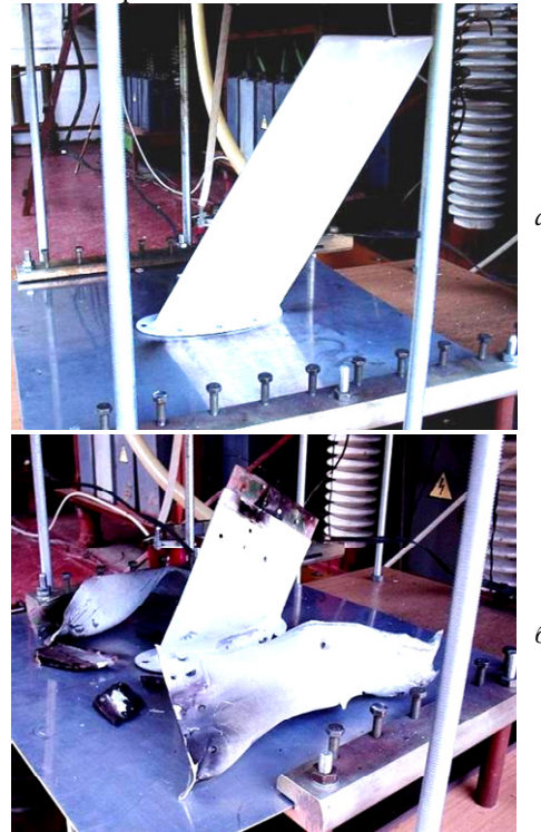
Рис. 19. Загальний вигляд дослідної моделі авіаційної приймально-передавальної антени ЛА до (а) і після (б) прямої дії на неї в сильнотривовому розрядному колі модернізованого потужного ГСБ типу УИТОМ-1 імпульсної A - компоненти струму штучної блискавки з нормованими АЧП ( I_{mA1} \approx 211,9 кА; t_{mA1} \approx 32 мкс; \tau_{p1A} \approx 500 мкс; J_{aA} \approx 2,1 \cdot 10^6 Дж/Ом) [16]
