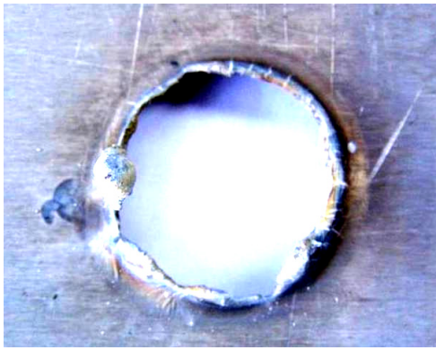
Рис. 16. Загальний вигляд внутрішньої округлої зони кризнього пропалювання листового ВЗ при випробуванні на блискавкостійкість обшивки ЛА з алюмінієвого сплаву марки АМг2М завтовшки h=1 мм від сумісної дії на нього в розрядному колі потужного високовольтного ГСБ типу УИТОМ-1 імпульсної A - і тривалої C - компонент повного струму штучної блискавки з нормованими АЧП
