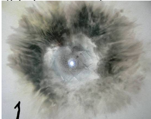
Рис. 17. Загальний вигляд з боку зони прив'язки результатів кризнього пропалювання на зовнішній поверхні ВЗ плоскої дюралюмінієвої панелі завтовшки h=1,2 мм обшивки паливного бака вітчизняного літака «Ан» плазмового каналу імітованого в розрядному колі потужного високовольтного ГСБ типу УИТОМ-1 штучного грозового розряду радіусом r_s \approx 3,7 мм його стінки від прямої дії нормованих A - ( I_{mA1} \approx 199,5 кА; t_{mA1} \approx 42 мкс; \tau_{p1A} \approx 500 мкс; J_{aA} \approx 1,99 \cdot 10^6 Дж/Ом), B - ( I_{mB} \approx 6,16 кА; I_{cB} \approx 2220 А; q_{LB} \approx 11,1 Кл; \tau_{p1B} \approx 5 мс) і C^* - ( I_{mC^*} \approx 1112 А; \tau_{p1C^*} \approx 13,6 мс; q_{LC^*} \approx 5,79 Кл; I_{cC^*} \approx q_{LC^*} / \tau_{p1C^*} \approx 426 А) компонент повного імпульсного струму штучної блискавки (зона ураження 1А) [17]
