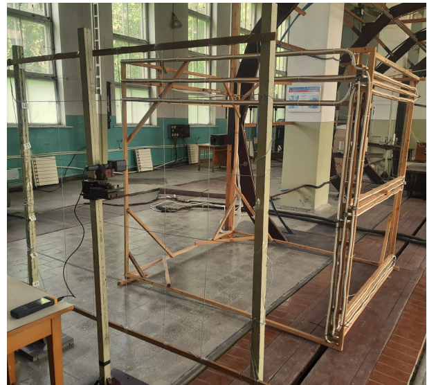
Рис. 9. Повномасштабний лабораторний макет струмопроводу низької напруги ТП 10/0,4 кВ, 100 кВА на магнітвиміральному стенді
