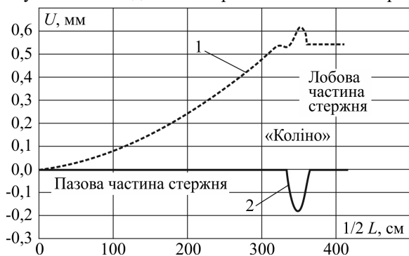
Рис. 3. Розподіл переміщень в ізоляції уздовж стержня
