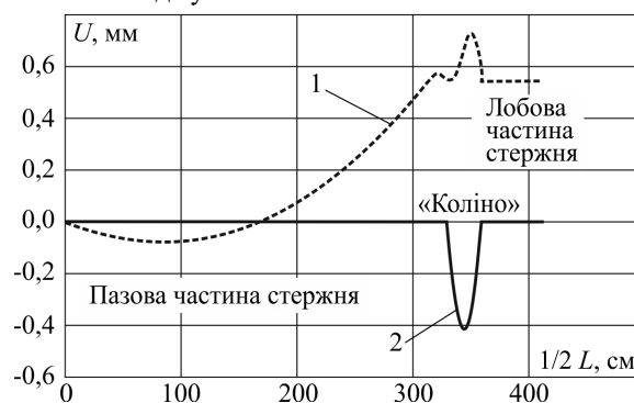
Рис. 5. Розподіл переміщень в ізоляції уздовж стержня
