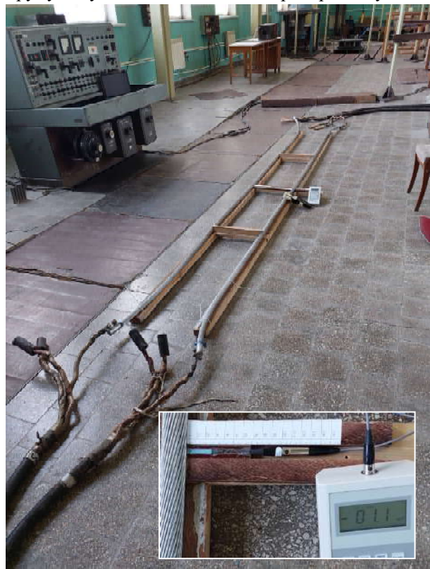
Рис. 8. Експериментальна установка з лабораторним макетом фази ЛЕП 330 кВ і пристроєм позиціонування датчика магнітометру
