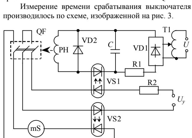
Рис. 3. Схема измерения собственного времени срабатывания автоматического выключателя
