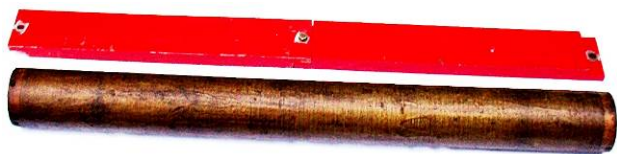
Рис. 4. Общий вид круглых цилиндрических «старых» (внизу) и плоских прямоугольных «новых» (вверху) зарядных резисторов R_C соответственно номиналом 500 Ом и 30 кОм, входящих в состав ЗРК соответственно мощных сверхвысоковольтных генераторов типа ГИИТ-4 и типа ГИИТ-2
