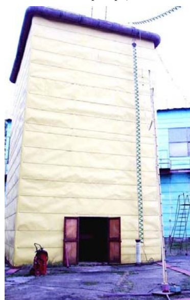
Рис. 2. Внешний вид модернизированного мощного сверхвысоковольтного сильноточного генератора типа ГИИТ-2, содержащего плоский со скатом стальной экран-крышу прямоугольной формы площадью 60 м 2 с круглыми закраинами (на переднем плане для измерения АВП формируемых на объекте испытаний импульсов напряжения установлен омический делитель напряжения на \pm 2,5 МВ типа ОДН-2)
