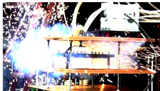
Рис. 10. Результаты электротеплового действия в разрядной цепи генератора тока искусственной молнии типа ГТМ-10/350 нормированного аperiodического импульса тока короткого удара грозового разряда временной формы 17/265 мкс с амплитудой I_m \approx -83,8 кА на опытный образец сетевого провода марки АППВнг2×6 с ПВХ изоляцией и сплошной алюминиевой жилой поперечным сечением 6 \text{ мм}^2 [23]
