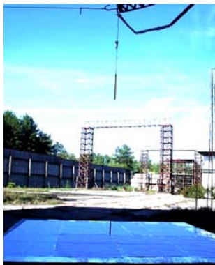
Рис. 14. Общий вид ОИ – двухэлектродной системы «игла-плоскость» с длиной воздушного промежутка 3 м, к верхнему электроду которой гальванически подсоединены ГКИН-2 и измерительный омический делитель импульсного напряжения ОДН-2 на номинальное напряжение \pm 2,5 МВ [29]
