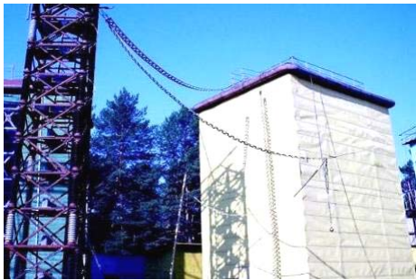
Рис. 11. Общий вид ГКИН-2, формирующего на испытуемом объекте электроэнергетики стандартный коммутационный аperiodический импульс напряжения временной формы T_g/\tau_p \approx 205/1900 мкс амплитудой U_m до 2 МВ (справа размещен модернизированный генератор ГИН-4, а слева установлена изоляционная опора высотой 11 м с нагрузочной емкостью C_f \approx 13,3 нФ на 3 МВ, к верхнему потенциальному электроду которой подсоединены от генератора ГИН-4 формирующий R_f \approx 4,28 кОм и от нагрузочной емкости – токоограничивающий R_T \approx 4,59 кОм резисторы) [24]
