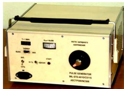
Рис. 16. Генератор типа TI-CS115 (NCS08), воспроизводящий на ОИ импульсные токи вида CS115 [9] и NCS08 [7]
