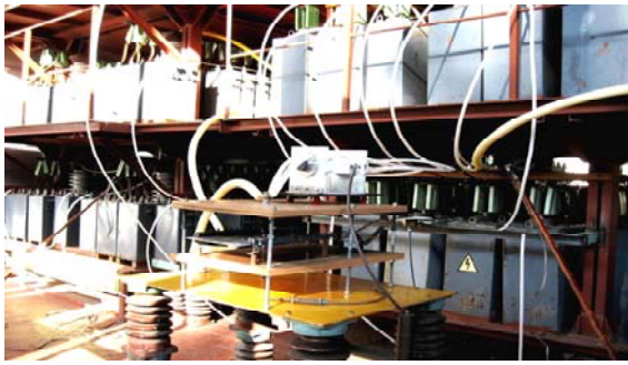
Рис. 7. Общий вид мощного высоковольтного сильноточного генератора тока искусственной молнии типа ГТМ-10/350 (на переднем плане находится его рабочий стол с размещенным сверху на нем управляемым высоковольтным трех-электродным воздушным коммутатором с графитовыми электродами на напряжение \pm 50 кВ и импульсный аperiodический ток молнии амплитудой до \pm 220 кА и испытываемым образцом кабельно-проводниковой продукции, а на заднем плане – электротехнические элементы зарядно-разрядных цепей его отдельных высоковольтных генераторов импульсных токов ГИТ-1, ГИТ-2, ГИТ-3 и ГИТ-4) [21]
