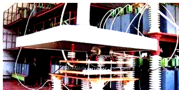
Рис. 1. Общий вид высоковольтного сильноточного ГТМ типа УИТОМ-1, моделирующего на ОИ прямое воздействие основных компонент тока искусственной молнии (на переднем плане находится рабочий стол с трехэлектродным управляемым воздушным коммутатором F_1 на электрическое напряжение \pm 50 кВ и системой воздушной вытжки, а на заднем плане размещены мощные высоковольтные генераторы ГИТ- A , ГИТ- D , ГИТ- B , ГИТ- C и ГИТ- C *) [17, 18]
