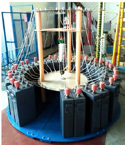
Рис. 25. Общий вид высоковольтного генератора импульсов тока типа G-NCS10, реализующего требования стандарта НАТО АЕСТР-500: 2016 при испытаниях ОБВТ по виду NCS10 (НИПКИ «Молния» НТУ «ХПИ», г. Харьков, 2018 г.)
