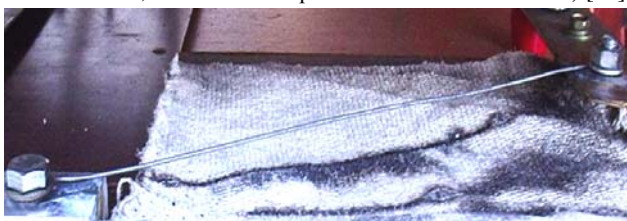
Рис. 2. Общий вид круглого оцинкованного стального провода ( r_0=0,8 мм; l_0=320 мм; \Delta_0=5 мкм; S_0=2,01 мм 2 ), размещенного в воздухе над теплозащитным асбестовым полотном и жестко закрепленного в разрядной цепи генератора ГИТ-С ( W_C \approx 310 кДж; U_C \approx -3,7 кВ) до протекания по нему аperiodического импульса тока большой плотности [9]
