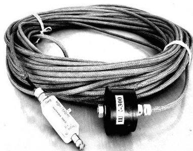
Рис. 5. Общий вид измерительного дискового коаксиального шунта типа ШК-300М1 в сборе с экранированной триаксиальной кабельной линией связи (длиной 70 м) и согласованно включенным в измерительный тракт специальным делителем напряжения типа СДН-300 с двумя коаксиальными разъемами 1:1 и 1:2, подсоединяемыми короткими отрезками кабеля к коаксиальным входам соответствующих цифровых запоминающих осциллографов [7, 17]
