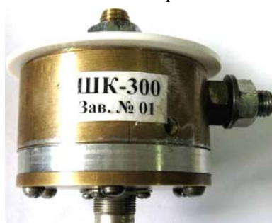
Рис. 4. Общий вид измерительного дискового шунта коаксиальной конструкции типа ШК-300М1, устанавливаемого в силовоточной разрядной цепи высоковольтной испытательной установки типа УИТОМ-1 и используемого для одновременной регистрации на экранах сразу трех цифровых запоминающих осциллографов АВП A ( D )-, B - и C ( C^* )- компонент тока искусственной молнии [17, 18]
