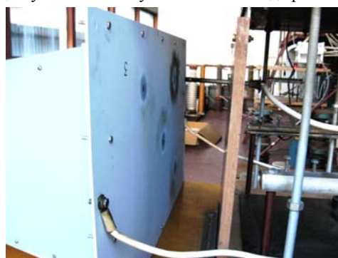
Рис. 8. Общий вид ИО плоской панели размером в плане 550×800 мм (толщиной h=3 мм) топливного бака самолета, вертикально закрепленного на торце изоляционной СНК и подключенного гибкими массивными медными шинами к сильноточной разрядной цепи высоковольтной испытательной установки типа УИТОМ-1, сразу после прямого воздействия на него (справа сверху) плазменного канала разряда с импульсным током искусственной молнии, моделирующим прямое термическое действие на ИО нормированных импульсов тока воздушного грозового разряда для зоны 1А
