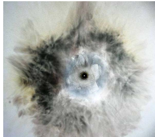
Рис. 12. Общий вид со стороны зоны привязки на наружной поверхности ИО плоской дюралюминиевой панели ( h=1,5 мм) топливного бака самолета плазменного канала имитированного на установке типа УИТОМ-1 грозового разряда результатов прямого воздействия на данный ИО для зоны 1А нормированных компонент тока искусственной молнии, характеризующихся локальным термическим повреждением стенки ИО панели в месте удара в него канала молнии
