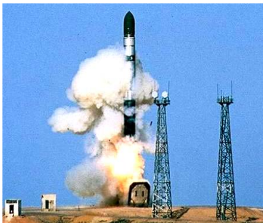
Рис. 7. Момент «минометного старта» из ШПУ советской боевой двухступенчатой тяжелой МБР типа Р-36М (военный индекс 15А14, по терминологии НАТО SS-18) [14]
