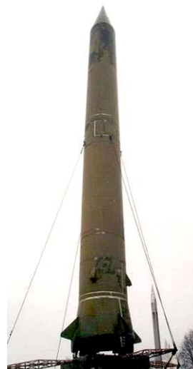
Рис. 2. Музейный экспонат одноступенчатой стратегической ракеты типа Р-12 (военный индекс 8К63) на стартовом столе (1957 г., Главный конструктор – М.К. Янгель) [9]
