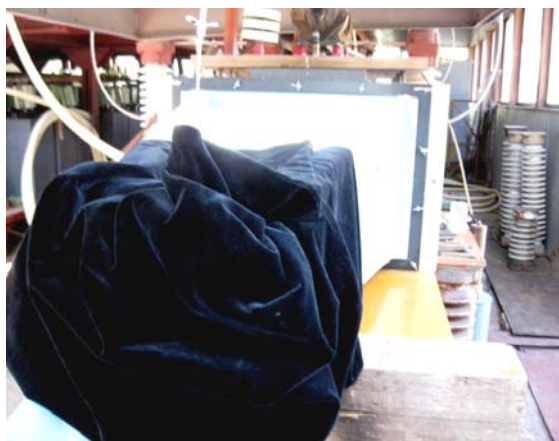
Рис. 7. Внешний вид пирамидальной СНК с фотокамерой на ее малом торце (камера укрыта светонепроницаемым защитным чехлом черного цвета) в процессе текущей регистрации термических искр с внутренней поверхности ИО, жестко и вертикально закрепленного на ее большом торце
