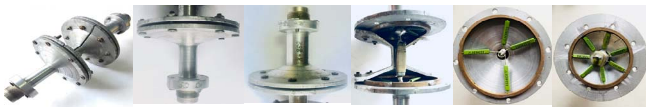
Рис. 2. Фото автономного резистивного экранированного низкоомного делителя напряжения (АРЭНДН)
