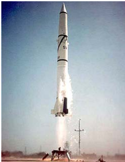
Рис. 4. Момент старта баллистической ракеты средней дальности «Редстоун» (длина – 21,1 м; диаметр – 1,78 м) с отделяющейся головной частью, созданной в США под научно-техническим руководством Вернера фон Брауна [11]
