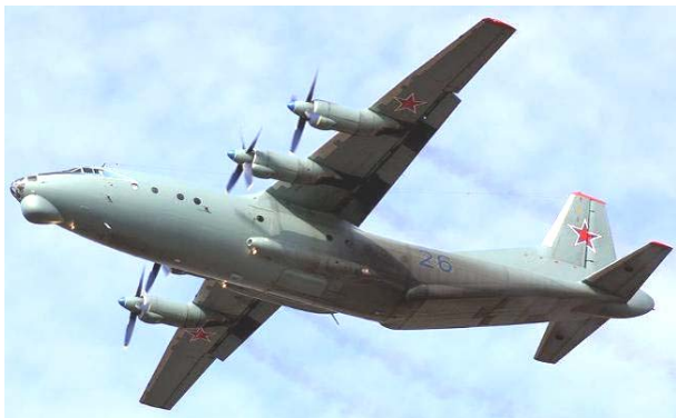
Рис. 5. Советский четырехмоторный турбовинтовой военно-транспортный самолет типа Ан-12 разработки Главного авиаконструктора О.К. Антонова и его ОКБ-473 (1959 г., г. Киев, УССР) [2]
