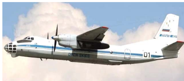
Рис. 8. Советский двухмоторный турбовинтовой аэрофотосъемочный самолет типа Ан-30 разработки авиаконструктора О.К. Антонова и его ОКБ-473 (1963 г., г. Киев, УССР) [2]
