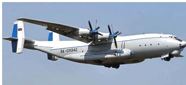
Рис. 9. Первый советский военно-транспортный четырехмоторный турбовинтовой самолет-гигант типа Ан-22 «Антей» (коммерческая нагрузка – 60 тонн; установил 12 мировых рекордов) разработки Генерального конструктора О.К. Антонова и его киевского ОКБ-473 (1965 г., г. Киев, УССР) [2]
