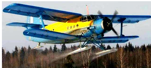
Рис. 2. Советский одномоторный поршневого пассажирский самолет-биплан типа Ан-2 «Аннушка» (известный многим как «Кукурузник») разработки авиаконструктора О.К. Антонова и его ОКБ-153 (1947 г., г. Новосибирск, СССР) [2]
