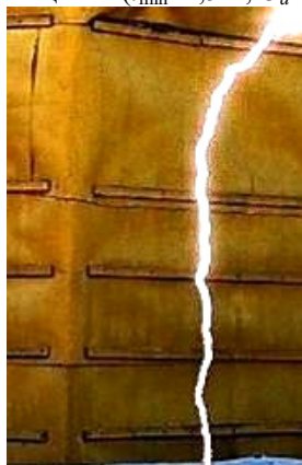
Рис. 7. Загальний вигляд зигзагоподібного циліндричного плазмового каналу іскрового розряду з майже сферичною зоною радіусом r \approx x_i активної ударної іонізації повітря, що яскраво світиться вгорі поблизу потенціального електрода ДЕРС «вістря-площина», при електричному пробі її повітряного проміжку комутаційним аперіодичним імпульсом високої напруги часової форми T_m/T_p \approx 200 мкс/1990 мкс позитивної полярності ( l_{\min}=1,5 м; U_e(T_d) \approx U_d \approx 611,6 кВ [27])
